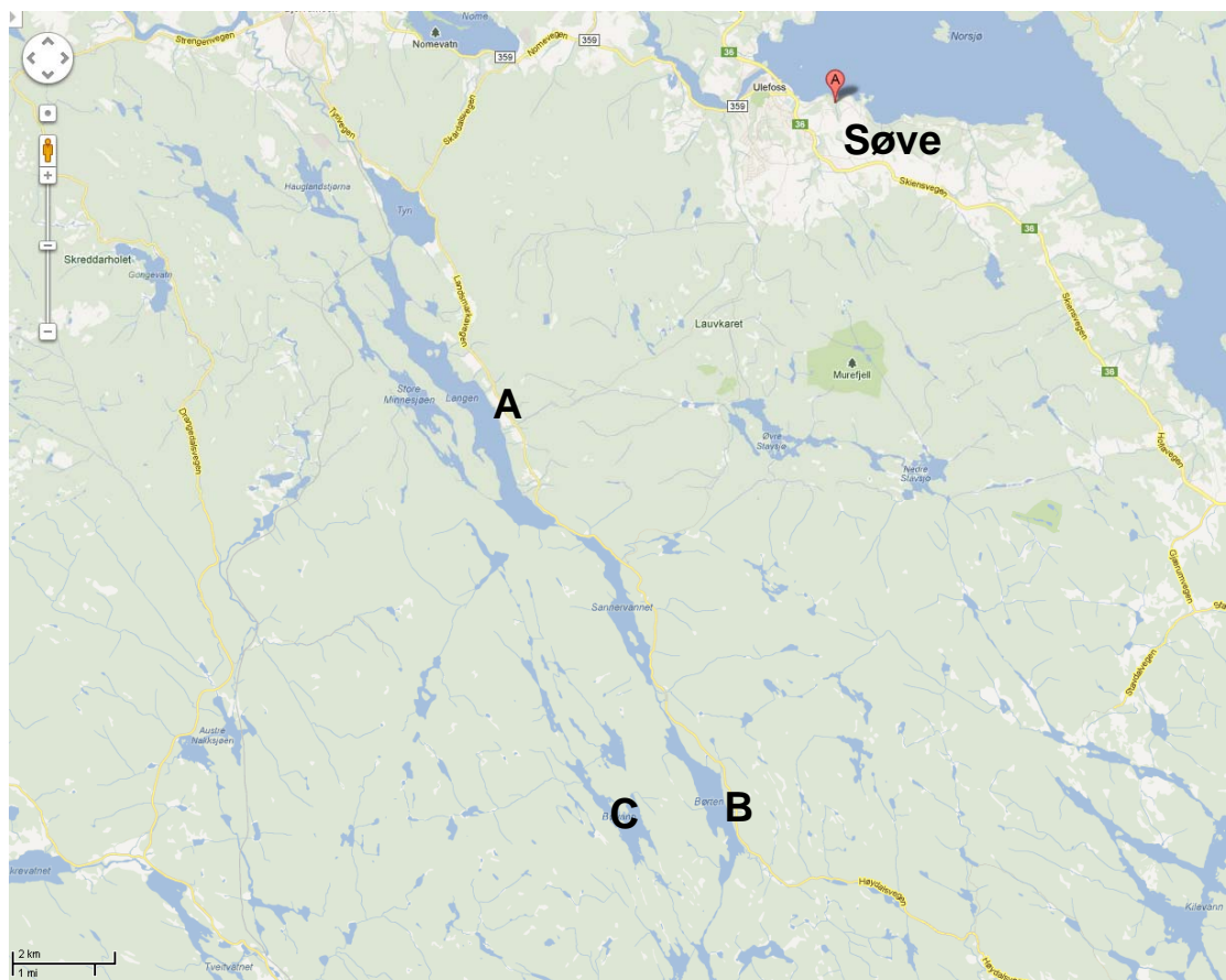
Figur 7 Mulige lokasjoner for semi-lokalt deponi. A: Langen 11,6 km, B:Børten 18,2 km, C:Bøvann 19,0 km fra Sørvest gruver
