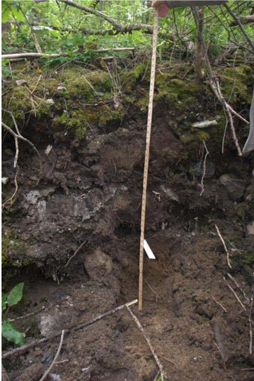
Figur 3 Uttak av dybdeprofiler fra sjakt i vaskerjord. Den hvite pinnen angir dybde 110 cm (40 cm over bunn)
